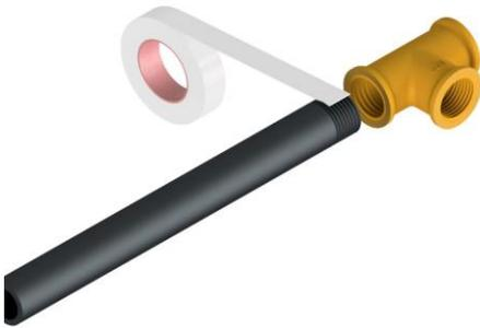
Um eine bestmögliche Dichtheit der Verbindung zu erzielen, empfehlen wir die Aufbringung eines geeigneten Dichtmittels z.B. unseren Gewindedichtfaden, Art.Nr. 114124 (Hanf nicht geeignet)
