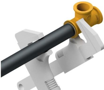
Verbinden Sie die Armatur mit der Leitung. Achten Sie darauf, dass die Leitung nicht in der Armatur überdreht wird. Überprüfen Sie hierzu bitte die Gewindelänge des Fittings und schrauben Sie das Rohr nicht über diese Länge hinaus. Vermeiden Sie mögliche Deformierungen der Armatur und der Leitung durch zu starken Anzug mittels Rohrzange.
